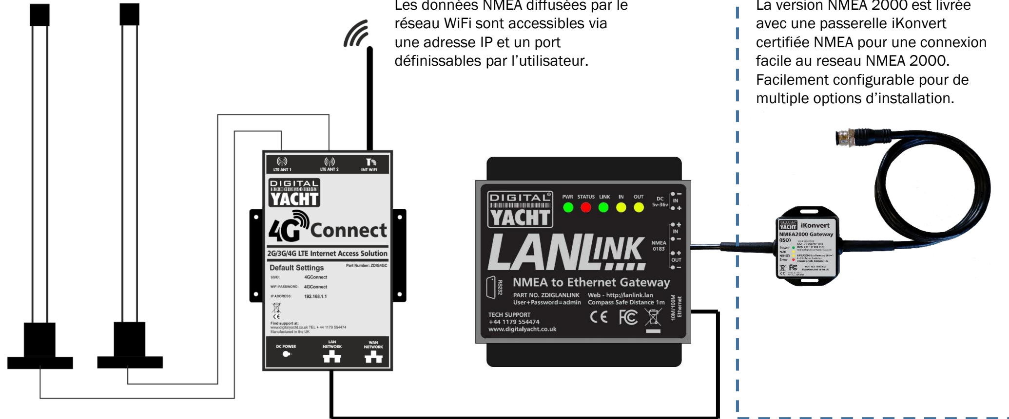
Connexion au routeur via un câble Ethernet RJ45.
